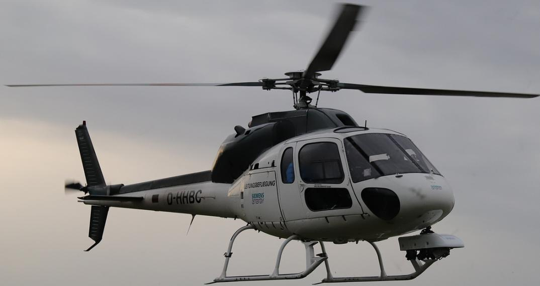
Am Helikopter sind Kameras und Sensoren montiert, mit denen die Bayernwerk Netz ihre Hochspannungsleitungen in Ostbayern digitalisiert.
