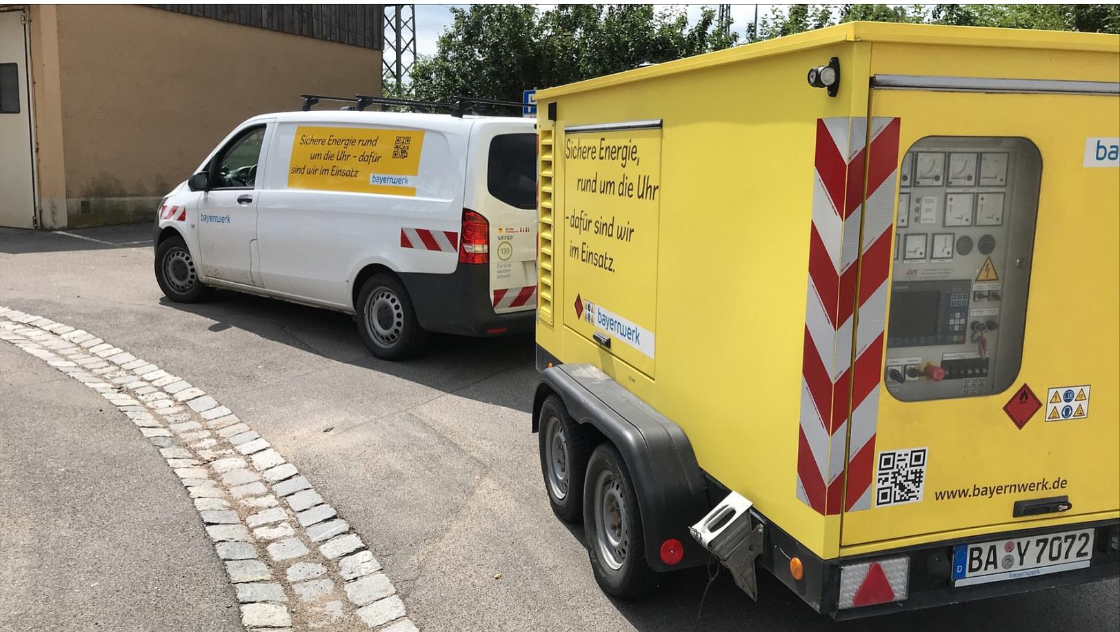
Energie schnell wiederherstellen: Mit Notstromaggregaten wie diesem hilft das Bayernwerk ab heute bei der Instandsetzung der Netzinfrastruktur in den Hochwassergebieten im Westen Deutschlands.
