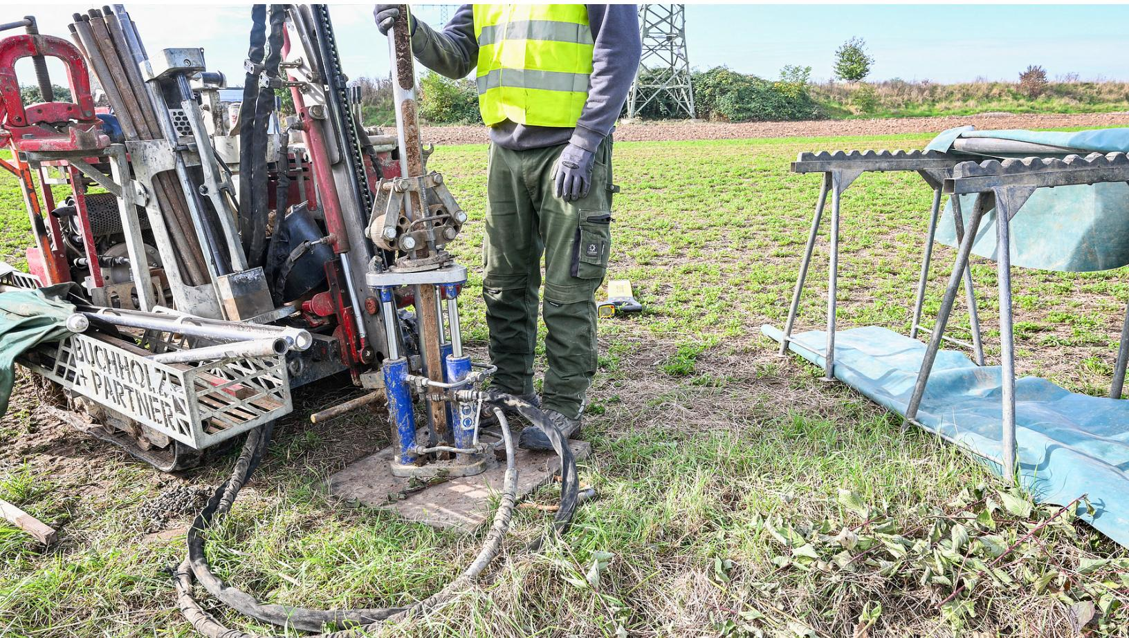
In Vorbereitung der Leitungsarbeiten zwischen den Umspannwerken Schwandorf und Regensburg ab untersucht die Bayernwerk Netz GmbH ab Anfang Januar 2026 an einzelnen Maststandorten die Bodenbeschaffenheit.
