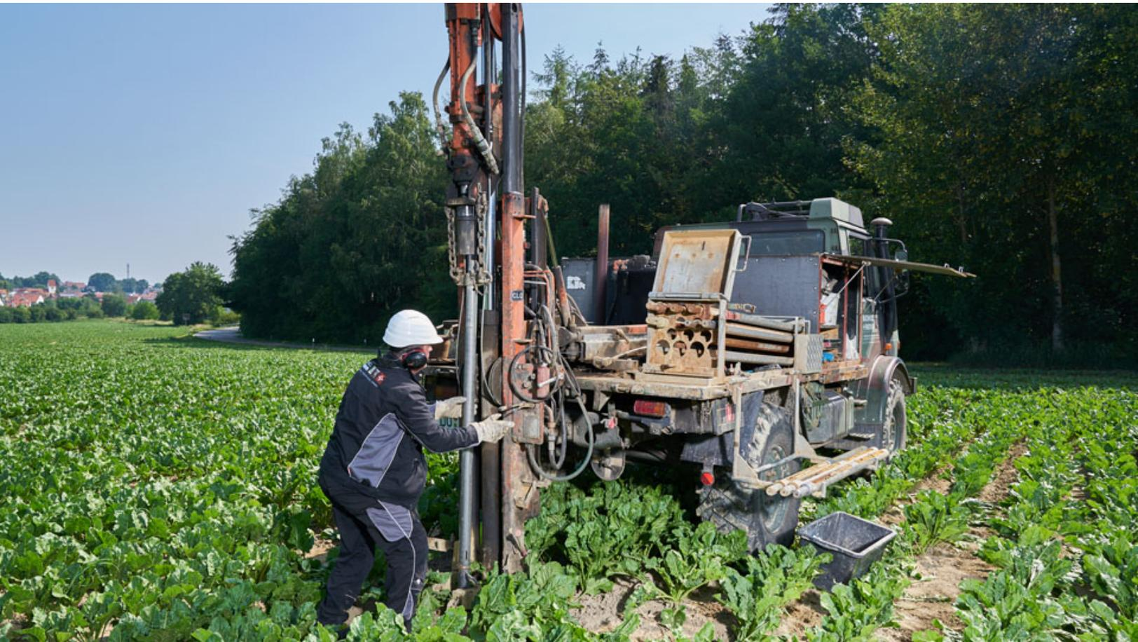
Planungsstart für Freileitungsbau im Landkreis Passau: Mit einem Bohrgerät an einem Unimog werden Proben aus dem Erdreich entnommen, wie hier im Vorfeld einer Leitungssanierung in Oberbayern.
