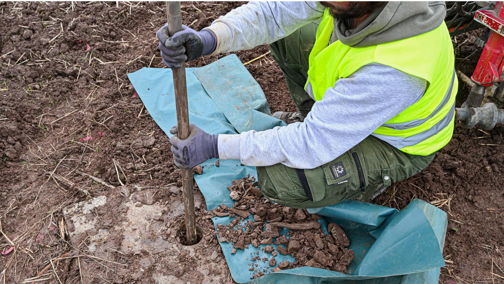
Zwischen Kastenweiher und Eltmann lässt die Bayernwerk Netz den Baugrund untersuchen. Die Tests geben Aufschluss über die Tragfähigkeit und die Beschaffenheit des Bodens und potenzielle Risiken.
