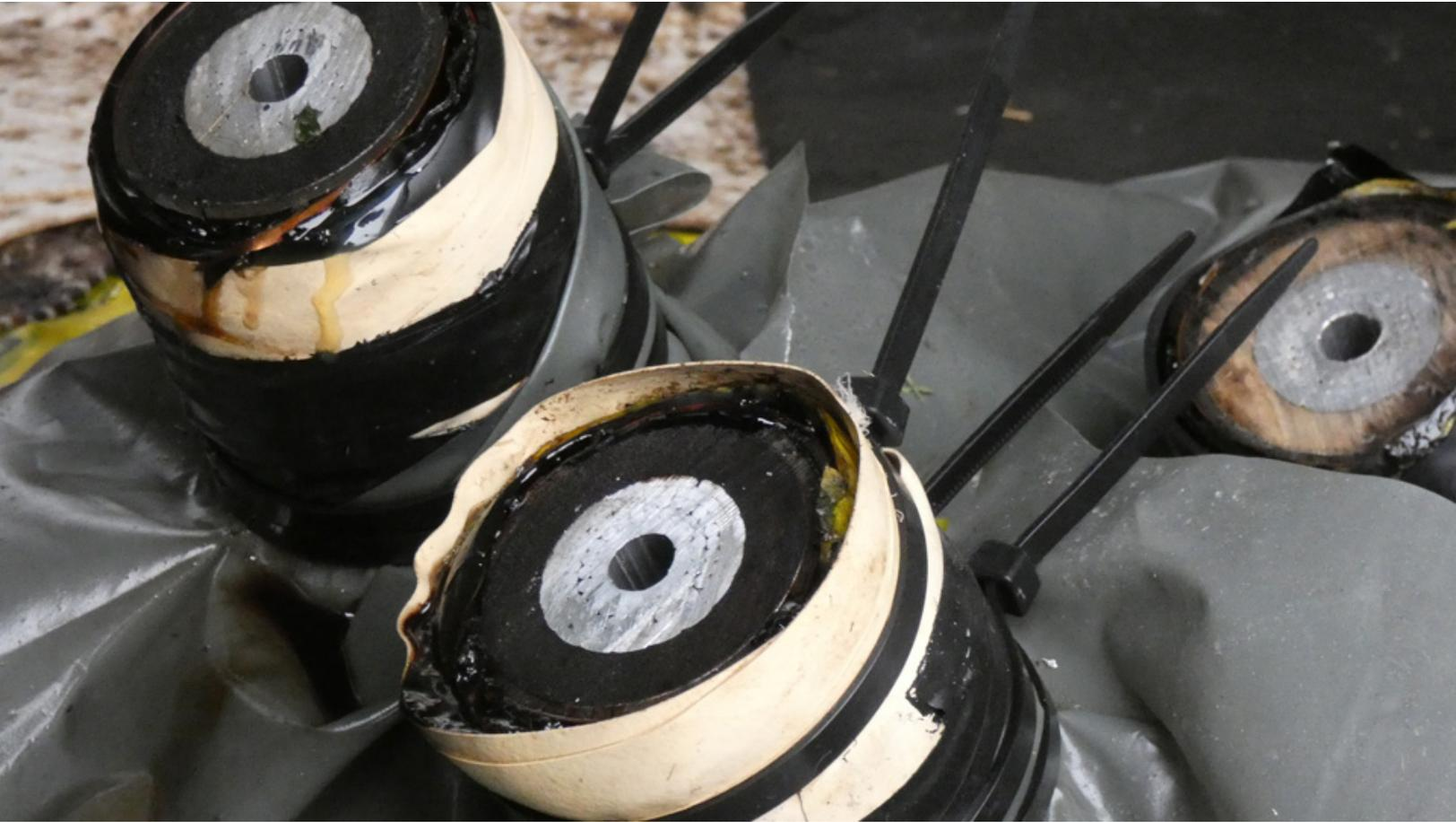
Ölisolierte Kabel vor dem Einsatz biologischer Minihelfer. Bakterien haben mehr als 95 Prozent des Öls aus den Kabeln entfernt.
