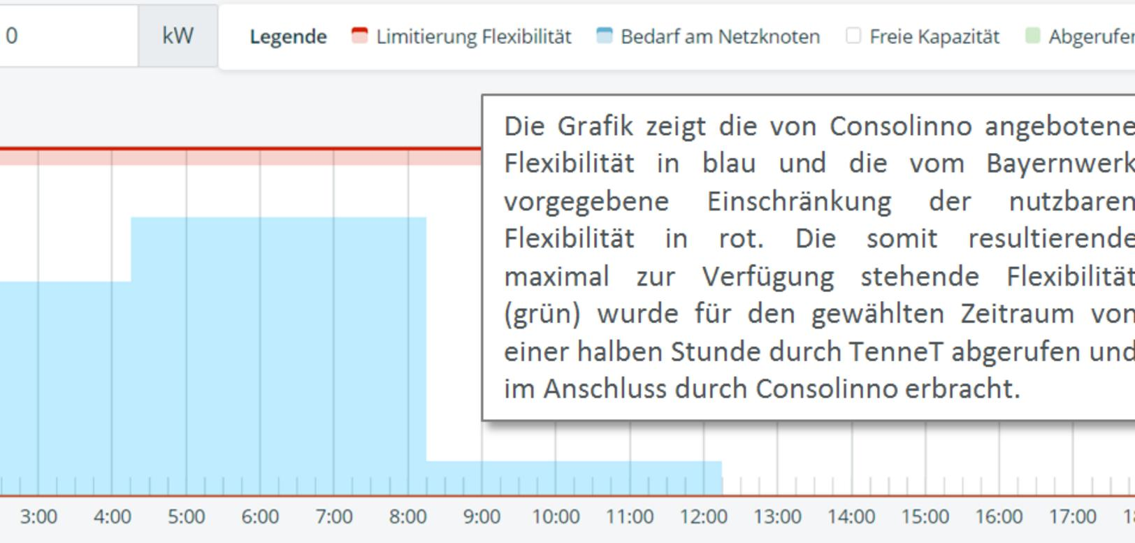
Die Grafik zeigt die von Consolinno angebotene Flexibilität in blau und die vom Bayernwerk vorgegebene Einschränkung der nutzbaren Flexibilität in rot. Die somit resultierende maximal zur Verfügung stehende Flexibilität (grün) wurde für den gewählten Zeitraum von einer halben Stunde durch TenneT abgerufen und im Anschluss durch Consolinno erbracht.
